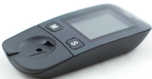
Modèle de lecteur de glycémie dont les éléments plastiques ont été soudés par laser
