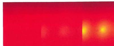
Diffusion de LED blanches sur différentes épaisseurs avec effets masquant ou non des LED (de gauche à droite : 3/2/1mm)
