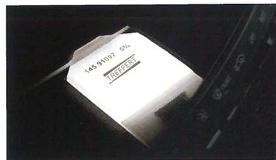
Effets diffusants pour la dissimulation des cartes électroniques et LED. Exemple avec un display intérieur de la Mercedes classe S. Crédit photo TREFFERT SAS
