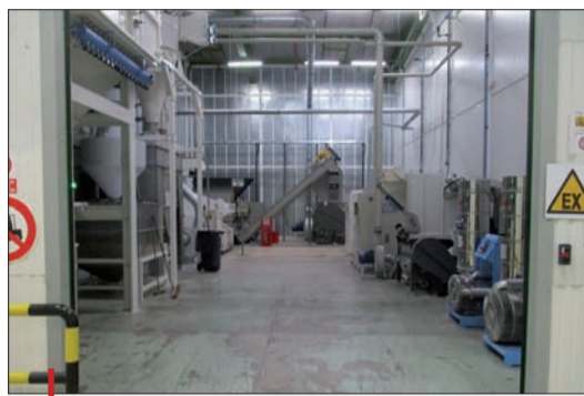
Vue intérieure du local de broyage. Sur la gauche au fond, arrivée du vrac Thermoformage (boîtes non conformes). Sur la droite, arrivée des bobines d'extrusion non-conformes. Au 1 er plan à gauche, on distingue les équipements de traitement d'air, transport matière, dépoussiérage, récupération des fines.
