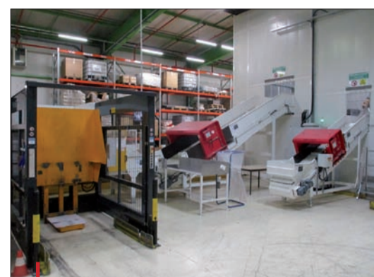
Ligne broyage vrac cristal thermoformage (à gauche) avec retourneur de caisse, détecteur de métaux, tapis montant vers le déchiqueteur Genox 75 kW. Toutes les cloisons sont insonorisées. Ligne vrac noir (à droite), mise en place à la main, détecteur de métaux, tapis montant vers un broyeur.
